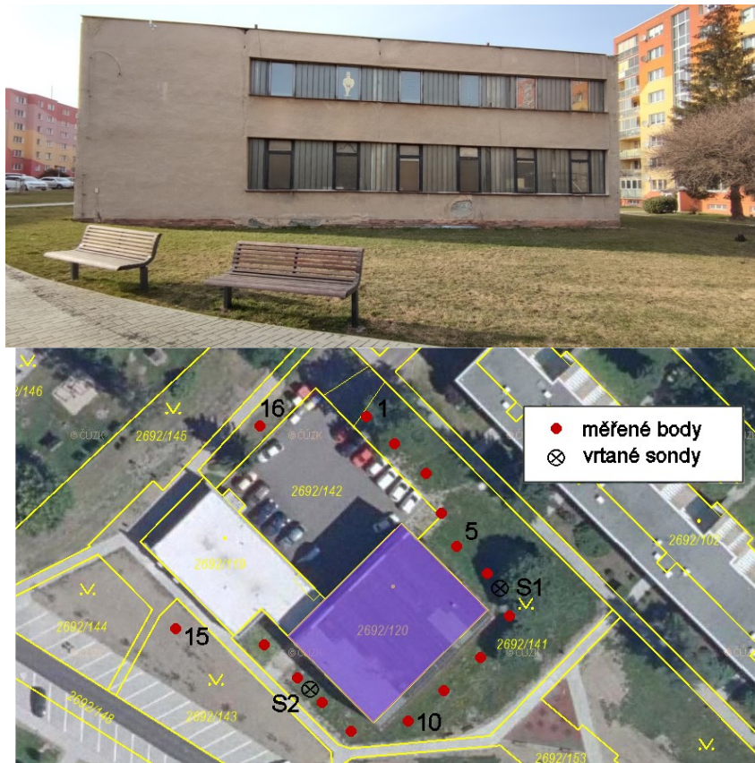
Obr. 1 – nahoře pohled na zájmovou budovu, dole situační plán se zakreslenými body měření a umístěním vrtaných sond
